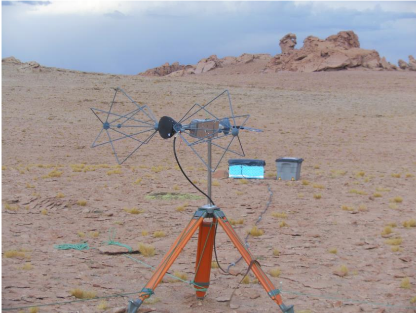
Radiómetro de 183 GHz para determinar niveles de vapor de agua
