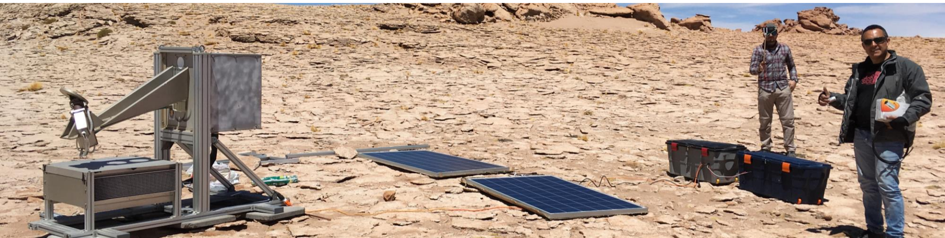
Radiómetro de 183 GHz para determinar niveles de vapor de agua
